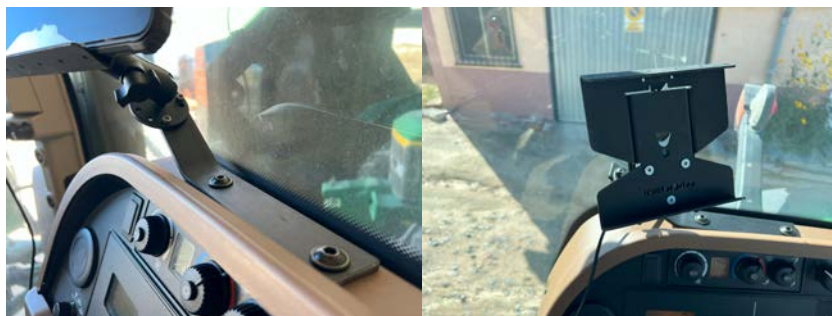
Figura 5: Pletina para la instalación del soporte (izquierda) y soporte instalado en la cabina (derecha)
