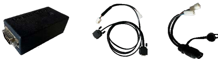
Figura 14: Modulo bluetooth (izquierda), cable de alimentación y datos (centro) y adaptador a DIN-9680 (derecha)
