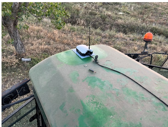
Figura 11: Antena y soporte sobre la cabina del tractor
