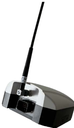
Figura 12: Antena de radio instalada en la antena GNSS-RTK
