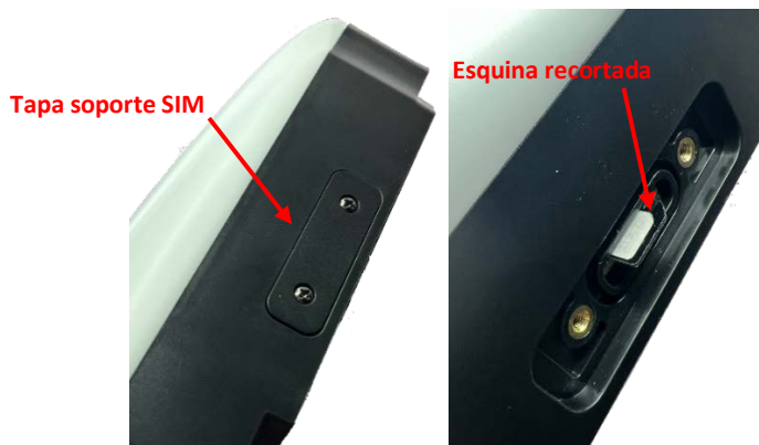
Figura 13: Tapa de la tarjeta SIM en la antena GNSS-RTK (izquierda) y tarjeta mini-SIM insertada en su soporte (derecha).
