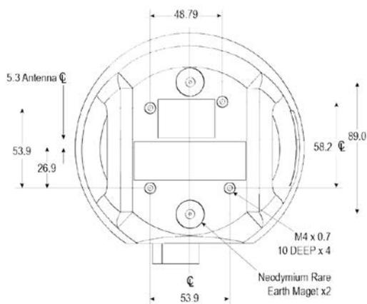
**Figura 8: Taladros de la base de la antena**
