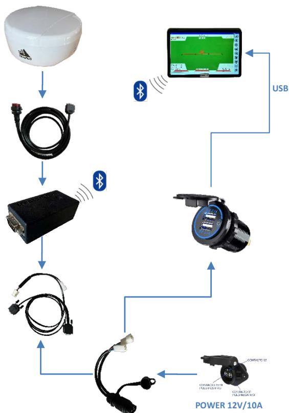
Figura 1: Diagrama de conexionado eléctrico
