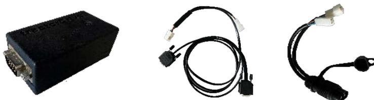
Figura 12: Módulo bluetooth (izquierda), cable de alimentación y datos (centro) y adaptador a DIN-9680 (derecha)
