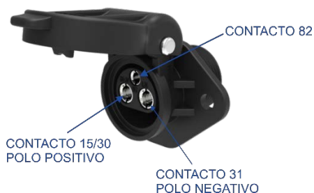
Figura 2: Contactos toma DIN-9680
