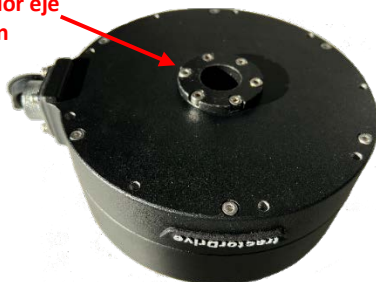
Figura 7: Instalación del adaptador del eje de dirección sobre el motor.
