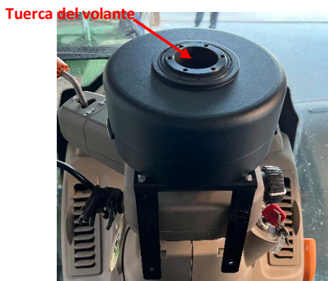
Figura 9: Motor de dirección con fijación antigiro sobre la columna de dirección.
