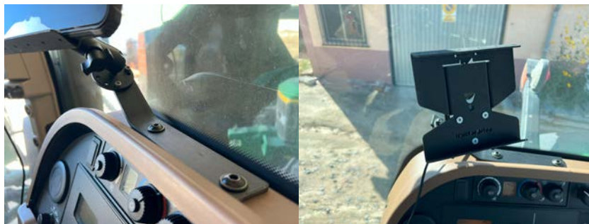
Figura 20: Pletina para la instalación del soporte (izquierda) y soporte instalado en la cabina (derecha)
