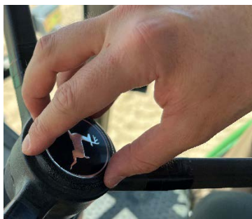
Figura 4: Extracción del embellecedor del volante
