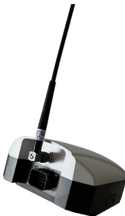
Figura 25: Antena de radio instalada en la antena GNSS-RTK
