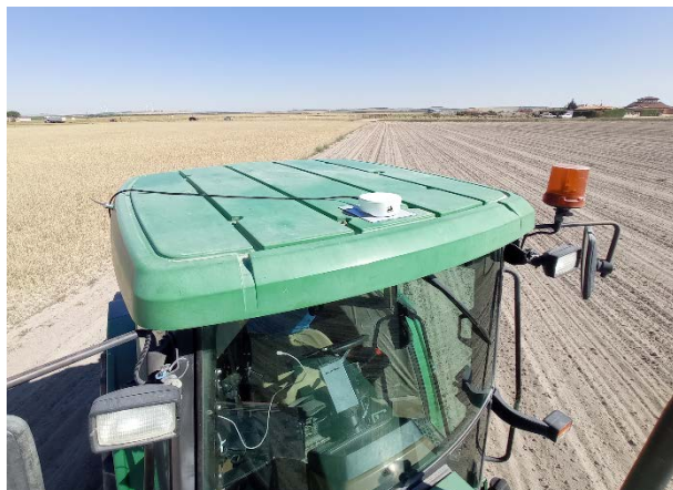
Figura 24: Antena y soporte sobre la cabina del tractor
