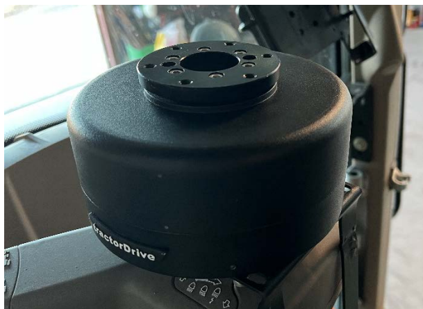
Figura 10: Motor de dirección con adaptador de volante.
