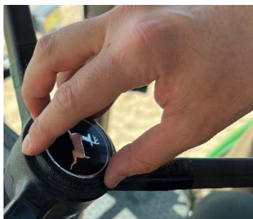
Figura 4: Extracción del embellecedor del volante
